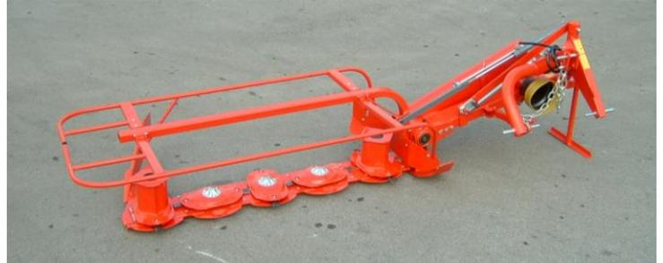
Provistas de un perfecto sistema de corte que no daña el producto. Escudos regulables, velocidad de avance alta, bajo desgaste y mantenimiento.
